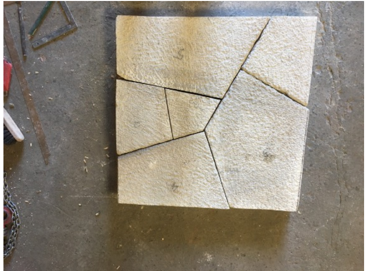
Anpassen der Oberflächenstruktur und des Verlegemusters in der Werkstatt
