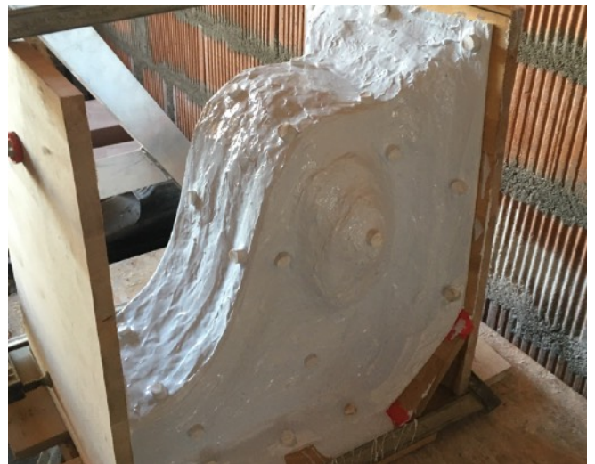
Negativformen aus Silikonabformmasse für die Abgüsse mit Romanzementmörtel
